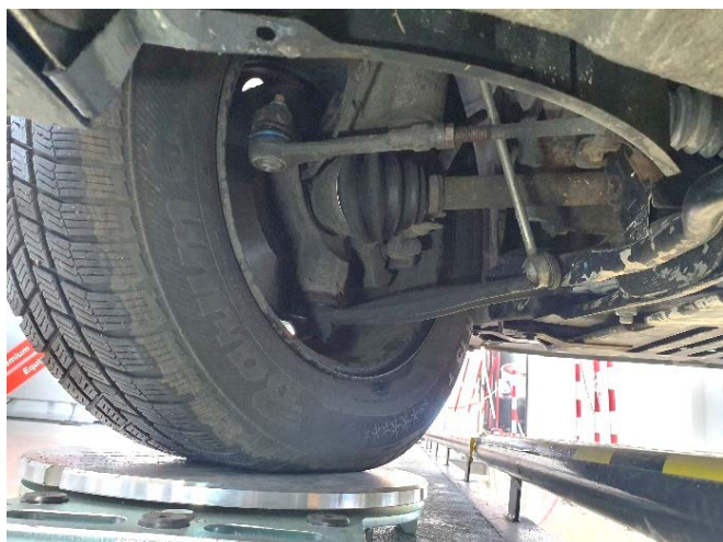
Obr. č. 5 a 6. Vizuálna kontrola funkcie mechanizmu riadenia vozidla nad kontrolnou jamou.
