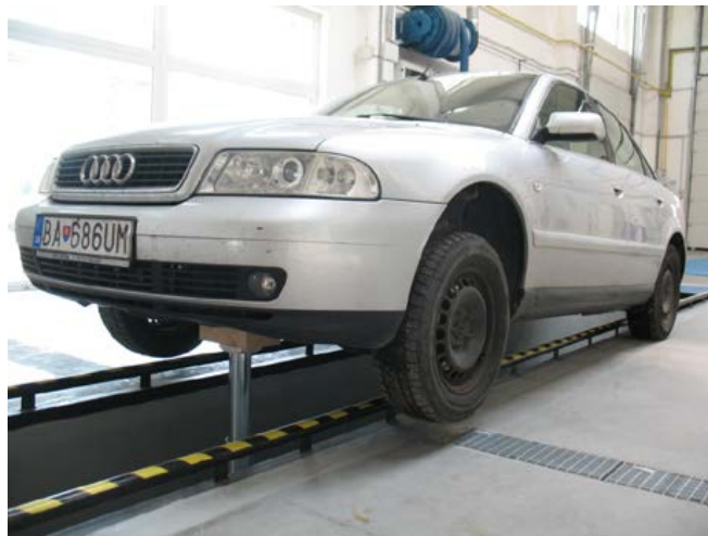
Obr. č. 2. Pridvihnutá riadiaca náprava ako alternatíva k použitiu otočných plošín.
