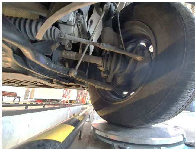
Obr. č. 5 a 6. Vizuálna kontrola funkcie mechanizmu riadenia vozidla nad kontrolnou jamou.
