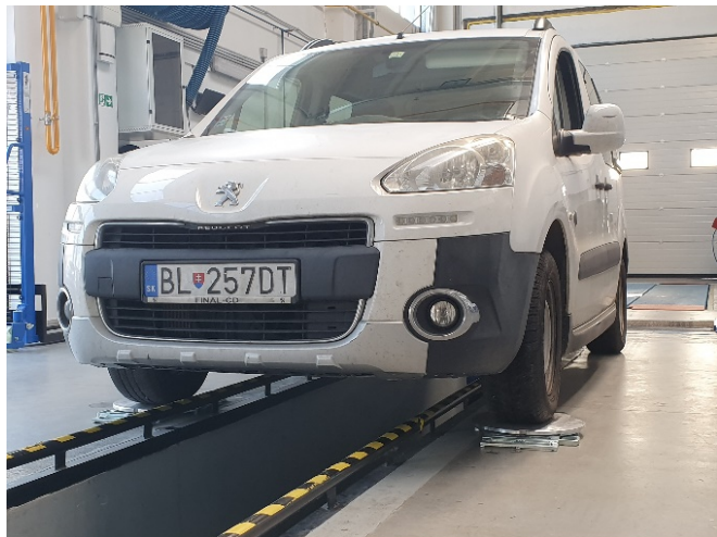
Obr. č. 1. Umiestnenie vozidla nad kontrolnou jamou s kolesami na otočných plošinách.
